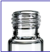
Kurzgewinde ND9 (die Gewindegänge hören in der Mitte des Halses auf, so dass Zwischen Kappenrand und Flaschenschulter noch Raum für (Roboter-)Greifarme besteht)
