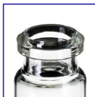
Headspace-Rand (abgeschrägter Rand)
